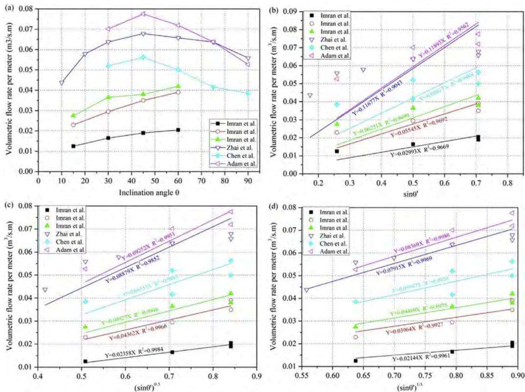
Fig. 3. Relationship between volumetric flow rate and: (a)  $\theta$ ; (b)  $\sin\theta$ ; (c)  $(\sin\theta)^{1/2}$ ; and (d)  $(\sin\theta)^{1/3}$ .
